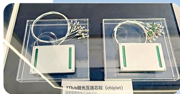
国家信息光子创新中心研发的2Tb/s硅光互连芯粒。
