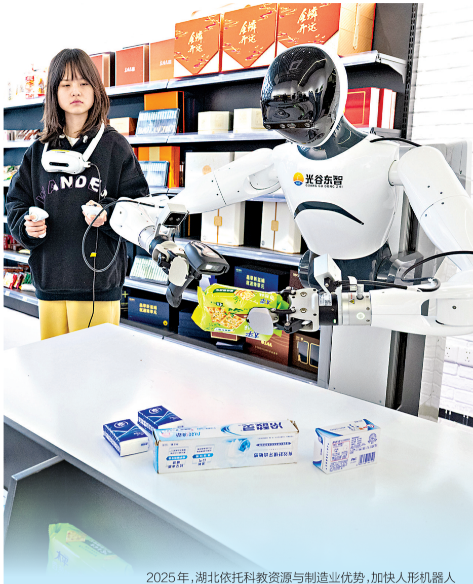
2025年,湖北依托科教资源与制造业优势,加快人形机器人产业链布局。图为湖北人形机器人创新中心,数据采集员操作人形机器人进行超市场景的数据采集。新华社记者肖艺九 摄
