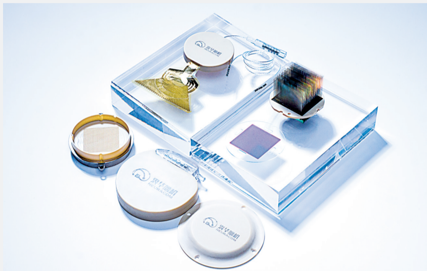
武汉衷华脑机的MEMS微电极阵列与脑机接口芯片,配合人工智能算法,让意念指令更精准、更稳定。
