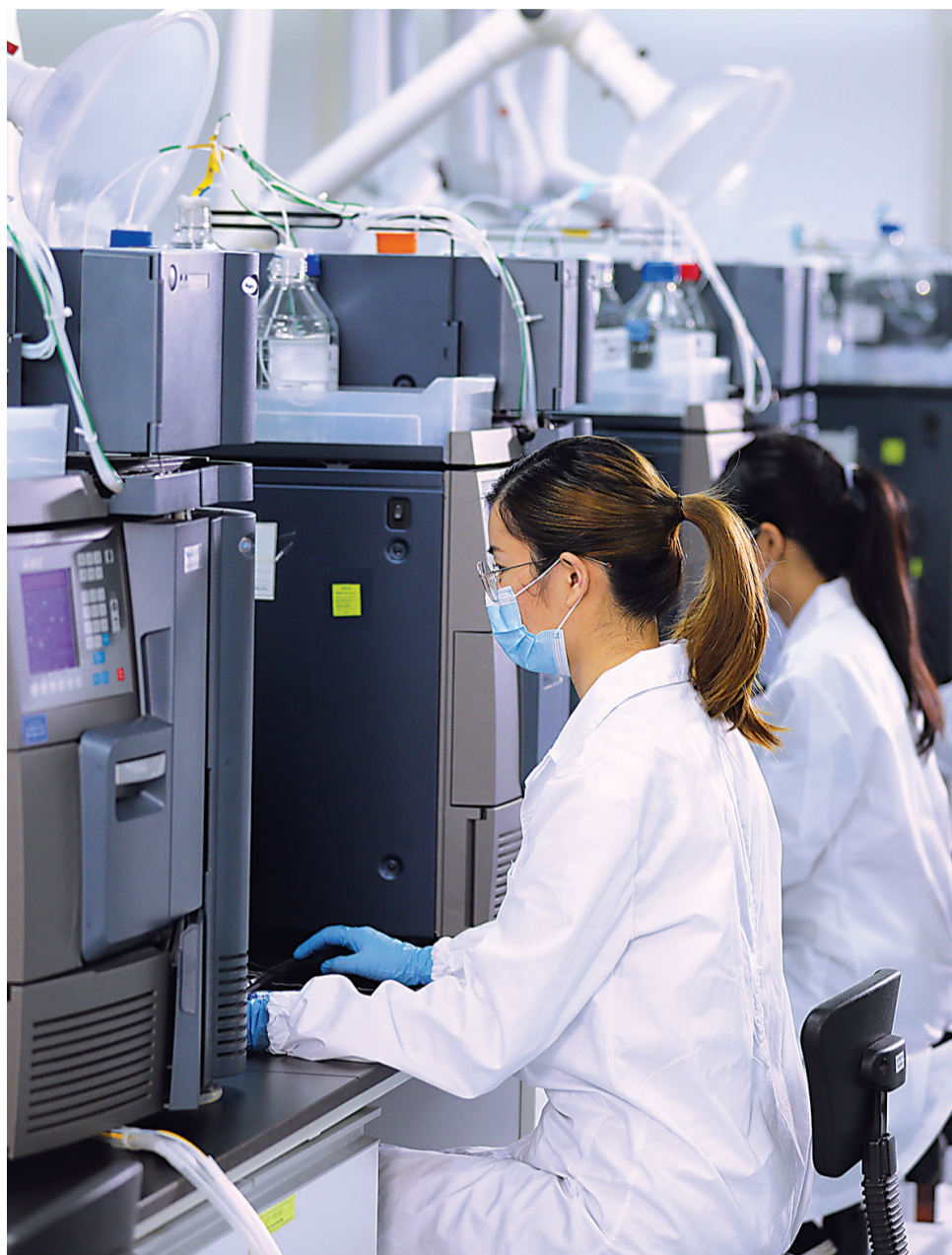
人福医药员工用液相色谱仪进行检测测试。
