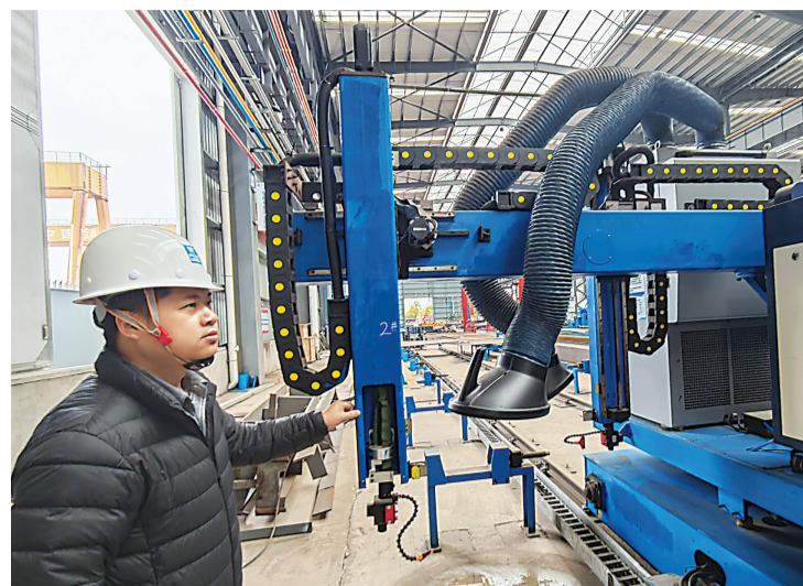
激光打磨机可实现高效率打磨与粉尘收集。
