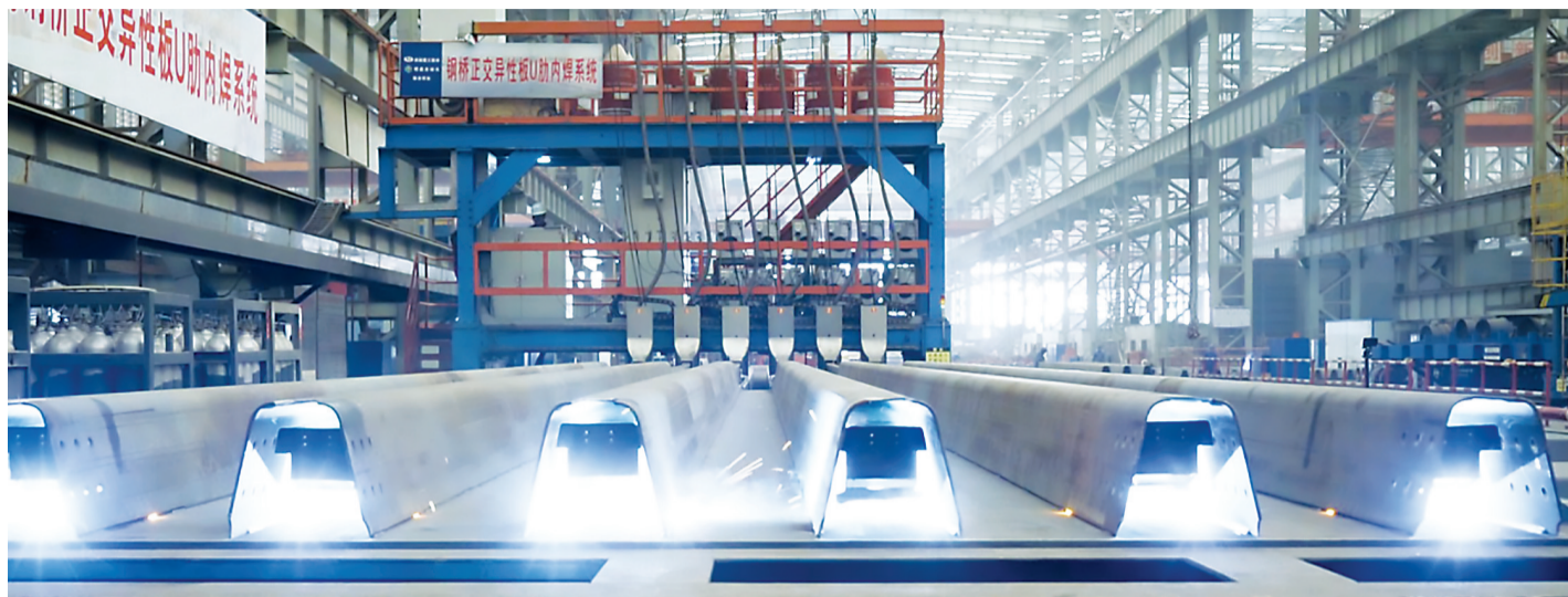
左图:锂鑫科技生产线正使用U肋内焊技术焊接U肋。通讯员王成林 摄 右图:锂鑫科技技术人员检查U肋焊接情况。通讯员王成林 摄
