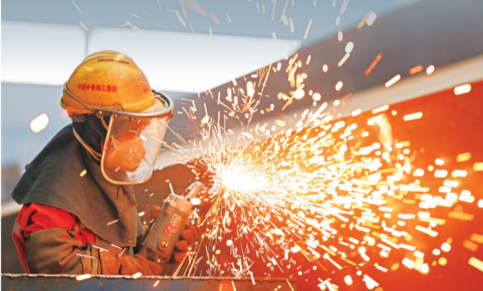
4月27日,在中铁科工集团武汉江夏制造基地,技术工人对钢结构配件进行打磨作业。 新华社发
