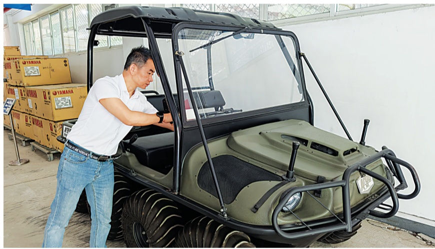
全地形水陆两用车既能在淤泥上前行,又可在水中推进。长江日报记者宋磊 摄
