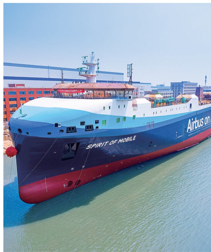
新型滚装船采用斜船架下水,像坐电梯一样平稳。
