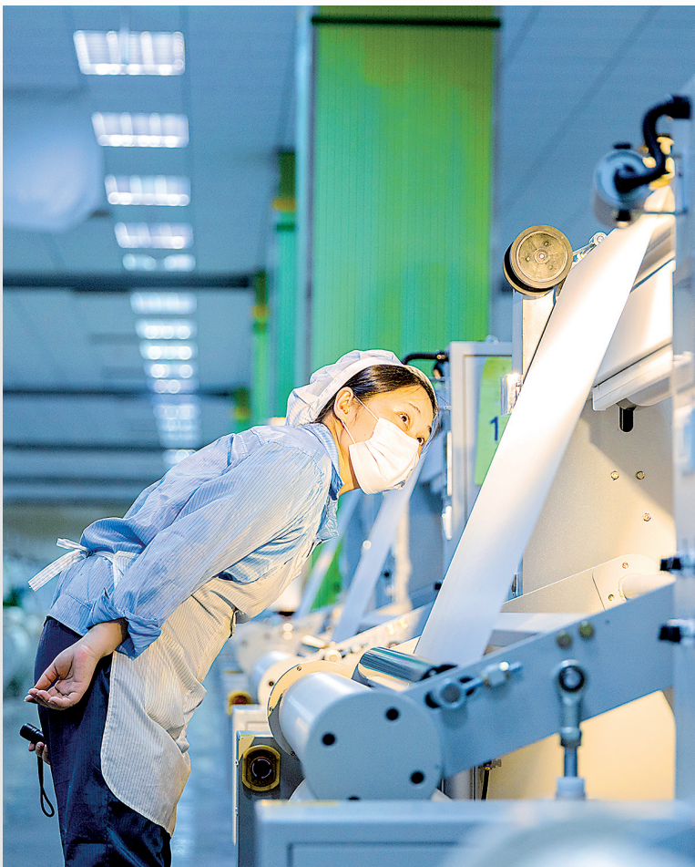
宏和电子能织出最薄9微米的玻纤布。
