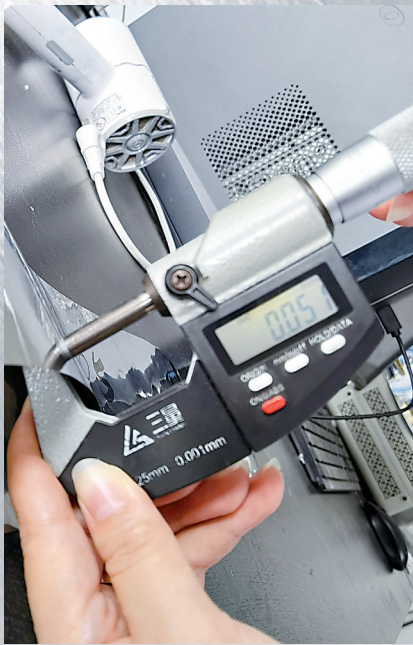
记者现场实测超薄硅钢只有0.05毫米厚。
