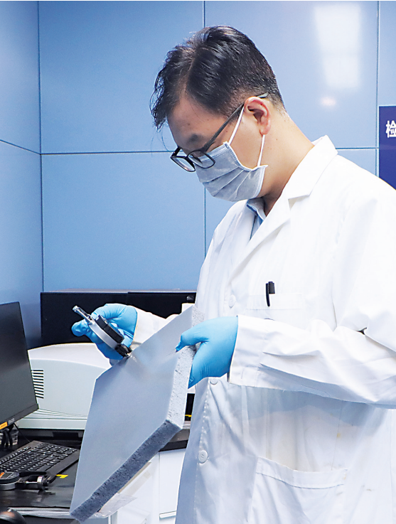
张创正在测试有机硅泡棉厚度及均一性。 通讯员汤光磊 摄
