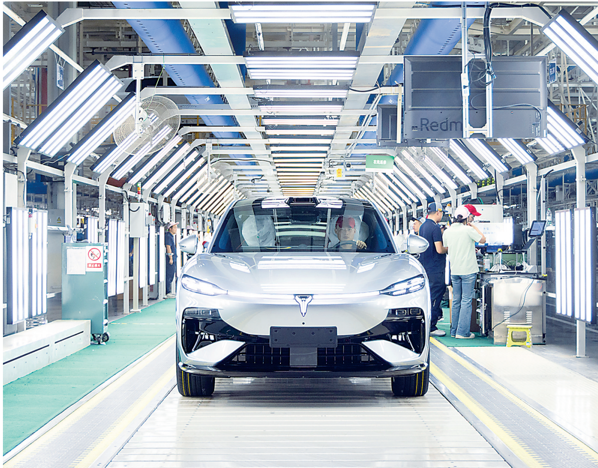
岚图云峰工厂单条总装线可兼容轿车、SUV、MPV跨轴距混流生产。
