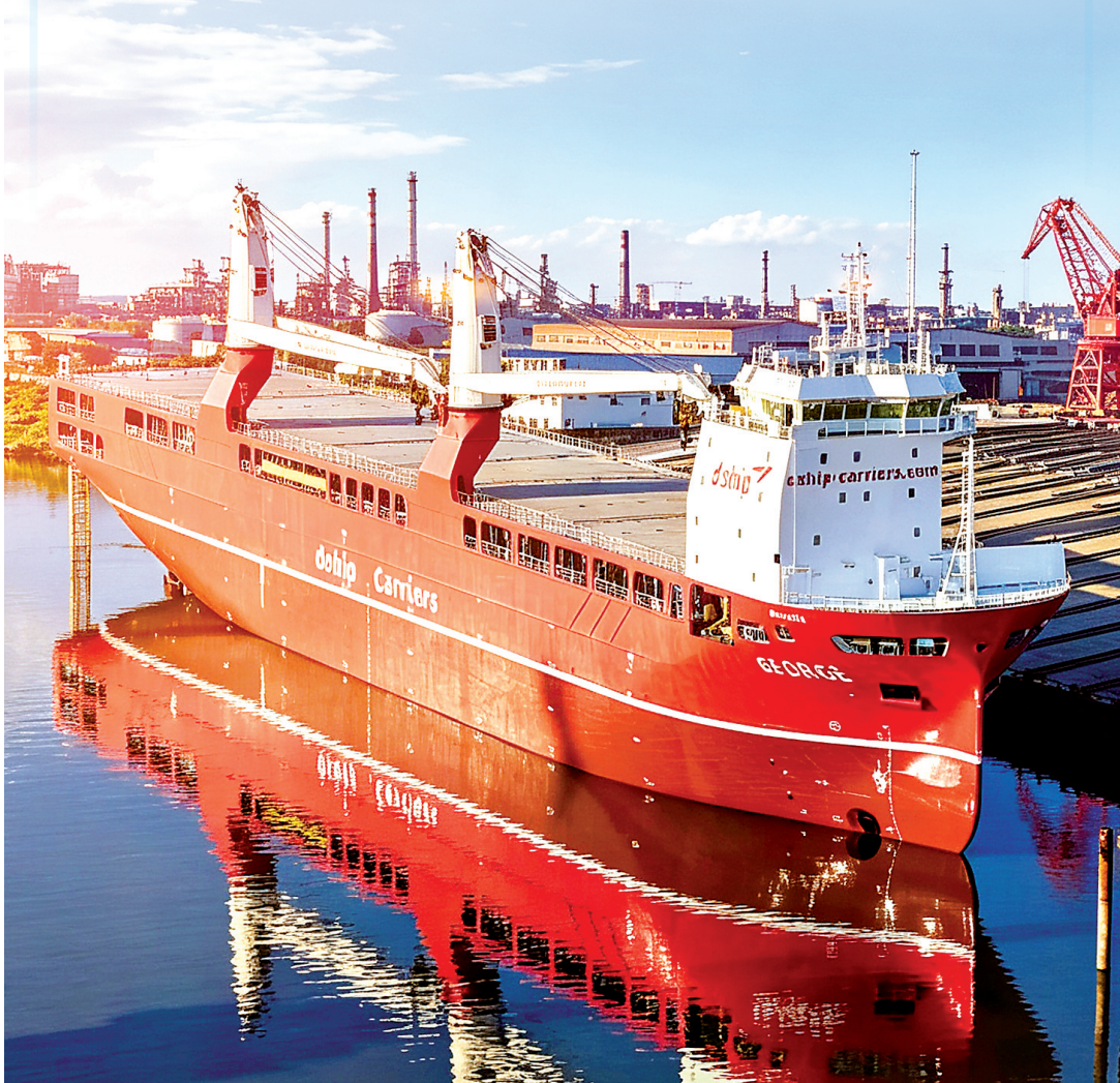
青山船厂为德国航运头部企业建造的 DC15000 吨多用途船青山 001。
