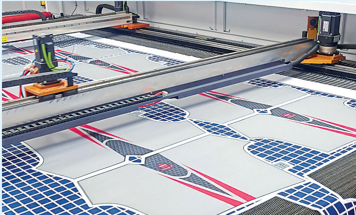
图腾体育生产车间内,激光裁片机对排版好的布料进行精准切割。 长江日报记者李沁雪 摄
