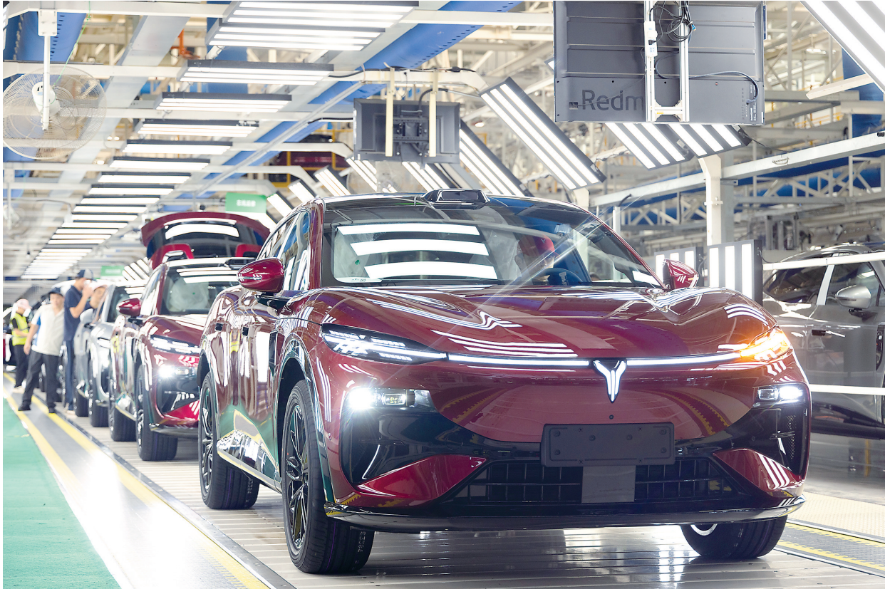
岚图云峰工厂总装线可兼容轿车、SUV、MPV跨轴距混流生产。图为岚图追光S缓缓驶出生产线。通讯员孙晓飞 摄
