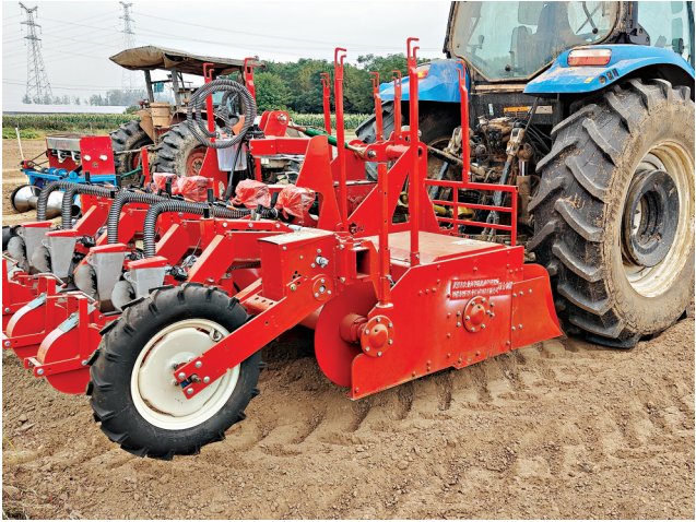
最新款的蔬菜复式精量播种机,套在拖拉机上就可以下田作业。
