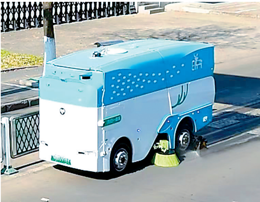
无人驾驶洗扫车在城市道路开展清扫作业。
